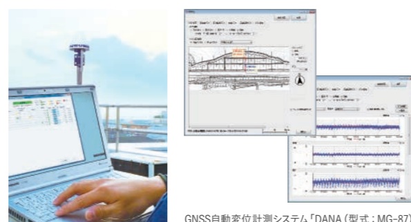
GNSS自動変位計測システム「DANA (型式: MG-87)」
