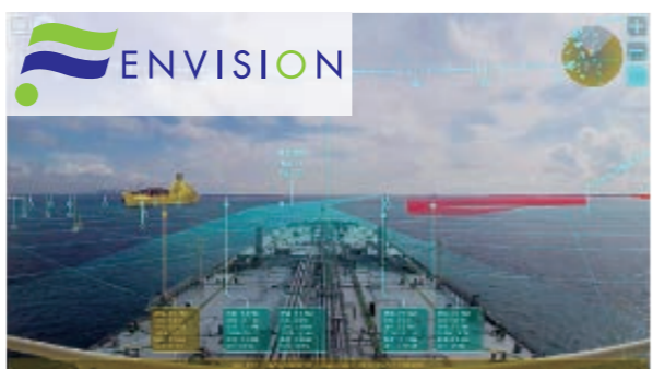
ARナビゲーション映像イメージ。方位、AIS、自船位置・針路・船速、ルートやウェイポイントなどの情報が重畳表示される
