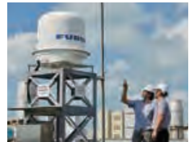
(シンガポール・PUB様に設置された小型気象レーダー)
