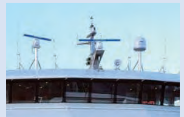
Seastreak社のCourageousフェリーに設置されているFURUNOレーダー
