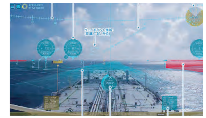
拡張現実(Augmented Reality)技術を活用し、航海中の周囲認知能力向上を支援するARナビゲーションシステム映像イメージ
