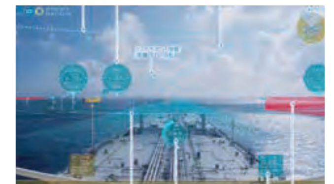
拡張現実(Augmented Reality)技術を活用し、航海中の周囲認知能力向上を支援するARナビゲーションシステム映像イメージ
