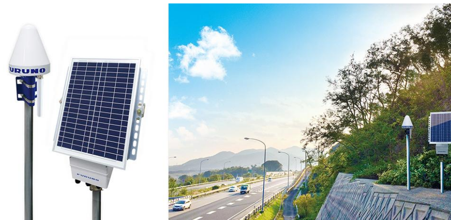
▲「DANA」の外観（左：GNSSセンサー、右：ソーラー電源）と観測イメージ
