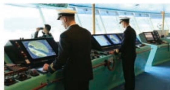
4K画質の高精細な大型スクリーン上に電子海図を表示した上で、タッチスクリーン操作で航海計画を作成するプランニングターミナル (航海計画作成支援システム) や、船上に設置したカメラの撮影映像に他船の航海情報などをAR (Augmented Reality) 技術で重畳表示して、乗組員の操船や見張り業務を視覚的に支援するARナビゲーションシステム、船内における主要航海機器の遠隔監視を実現するタブレットソリューションなど、早期実用化をめざしています。
