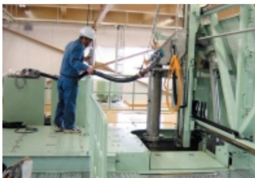
縦11m、横5m、深さ6.5m の水槽に設置された試験装置
