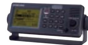
GMDSSに対応した最大500W出力のSSB送受信機「FS-5070」は、遭難警報メッセージや一般呼出メッセージの送受信ができるGMDSS用デジタル選択呼出機能とDSC聴守受信機能を内蔵しており、船内での装備性が向上しました。また、緊急時等の位置通報精度を大幅に高め、最新のDSC規格に準拠することで、航行安全性をより高めています。
